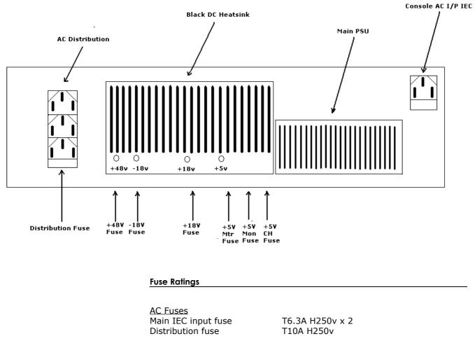
DC Fuses +/-16V +5V Meters +5V Channels +5V Monitor +48V
